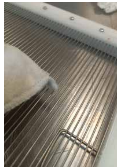
Na žicah se lahko naberejo strup in nečistoče, ki zmanjšujejo učinkovitost naprav.
