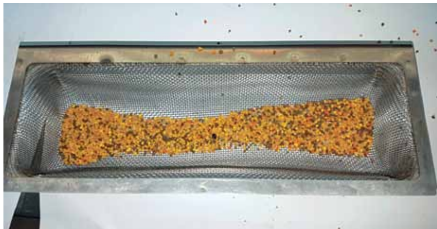
Predalček prototipa je izdelan iz nerjaveče kovinske mreže
